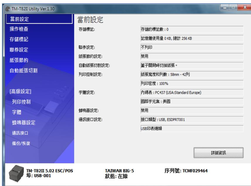
操作設定底下可以選"通訊測試"測試列印機跟電腦是否連結成功，底下"測試列印"可測試列印功能。如下圖：
