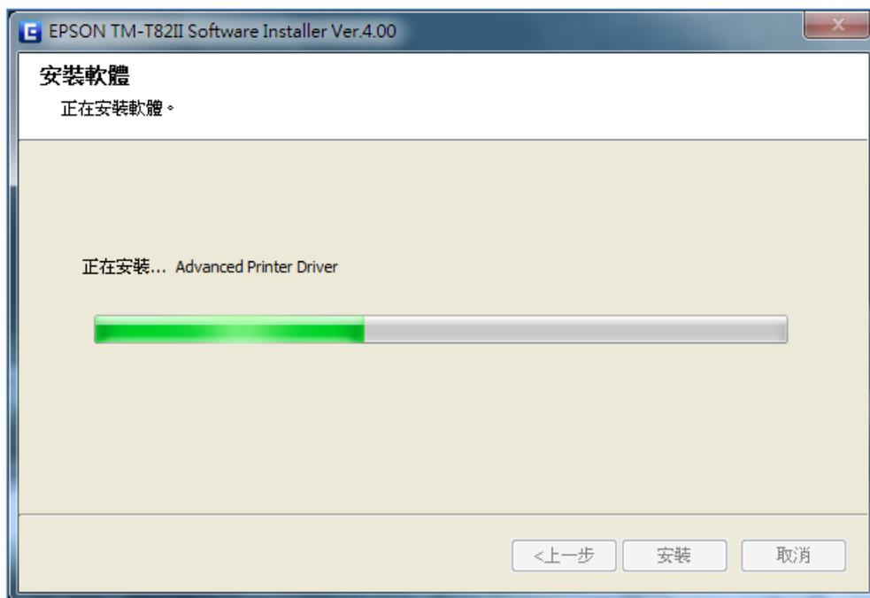
安裝至一半請依畫面指示將列印機 USB 傳輸線另一頭插入電腦的 USB 孔並打開列印機電源，讓它偵測到列印機已接入電腦點選下一步。如下列圖：
